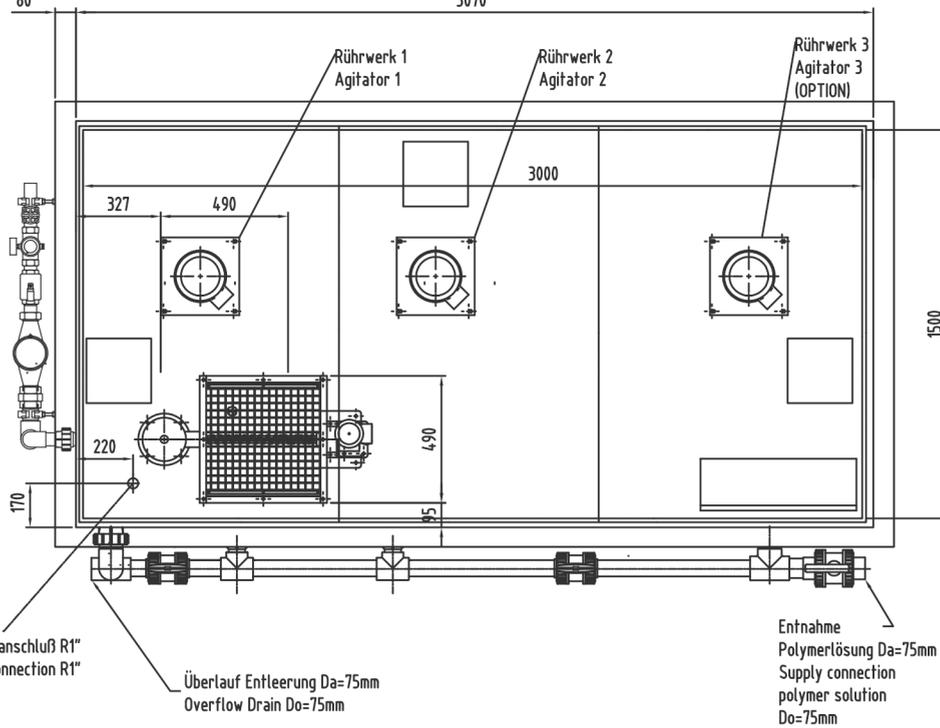
Lage von Entnahme, Überlauf und Entleerung ist wählbar.
