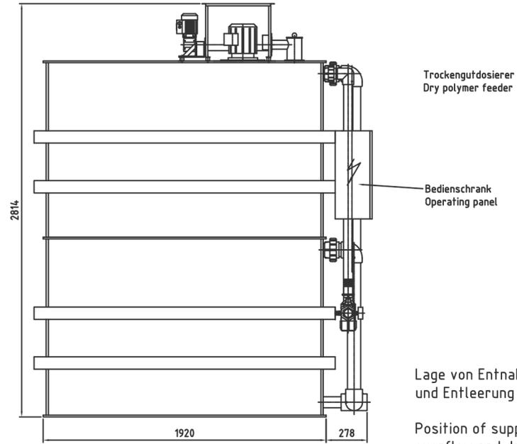
Lage von Entnahme, Überlauf und Entleerung ist wählbar.
