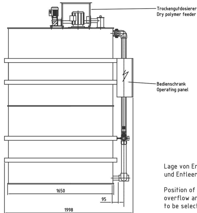
Lage von Entnahme, Überlauf und Entleerung ist wählbar.
