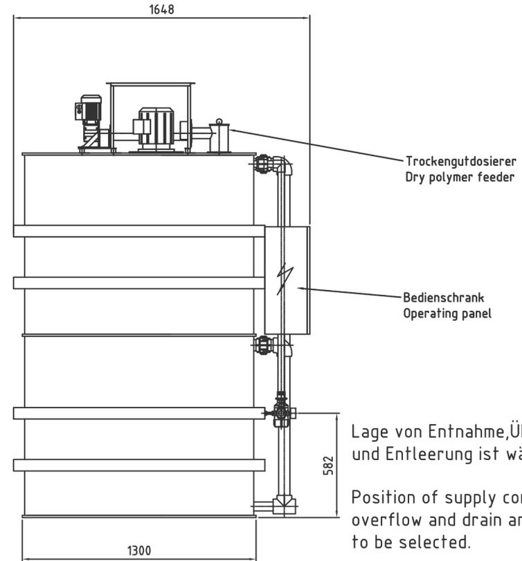
Lage von Entnahme, Überlauf und Entleerung ist wählbar.
